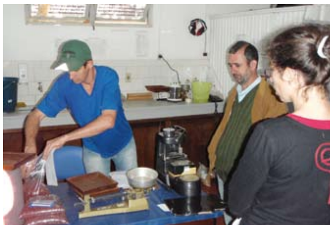
Sous l'œil vigilant du représentant des producteurs, le technicien de l'entreprise exportatrice réalise le calibrage, la mesure des impuretés et de l'humidité de la récolte afin de déterminer le prix attribué (ici, il s'agit de haricots rouges mais la méthode est la même pour le soja).
